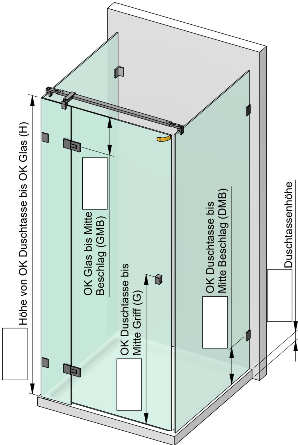
Die hier dargestellte Verwendung von Stabilisationsstangen ist als Beispiel anzusehen. Größe und Position der Stabilisationsstangen ist abhängig von der Glasgröße!
