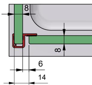
c) mit Dichtprofil 8861KU0-8 und Türanschlag z.B. 20215
