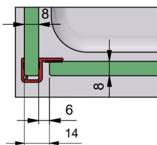
c) mit Dichtprofil 8861KU0-8 und Türanschlag z.B. 20215
