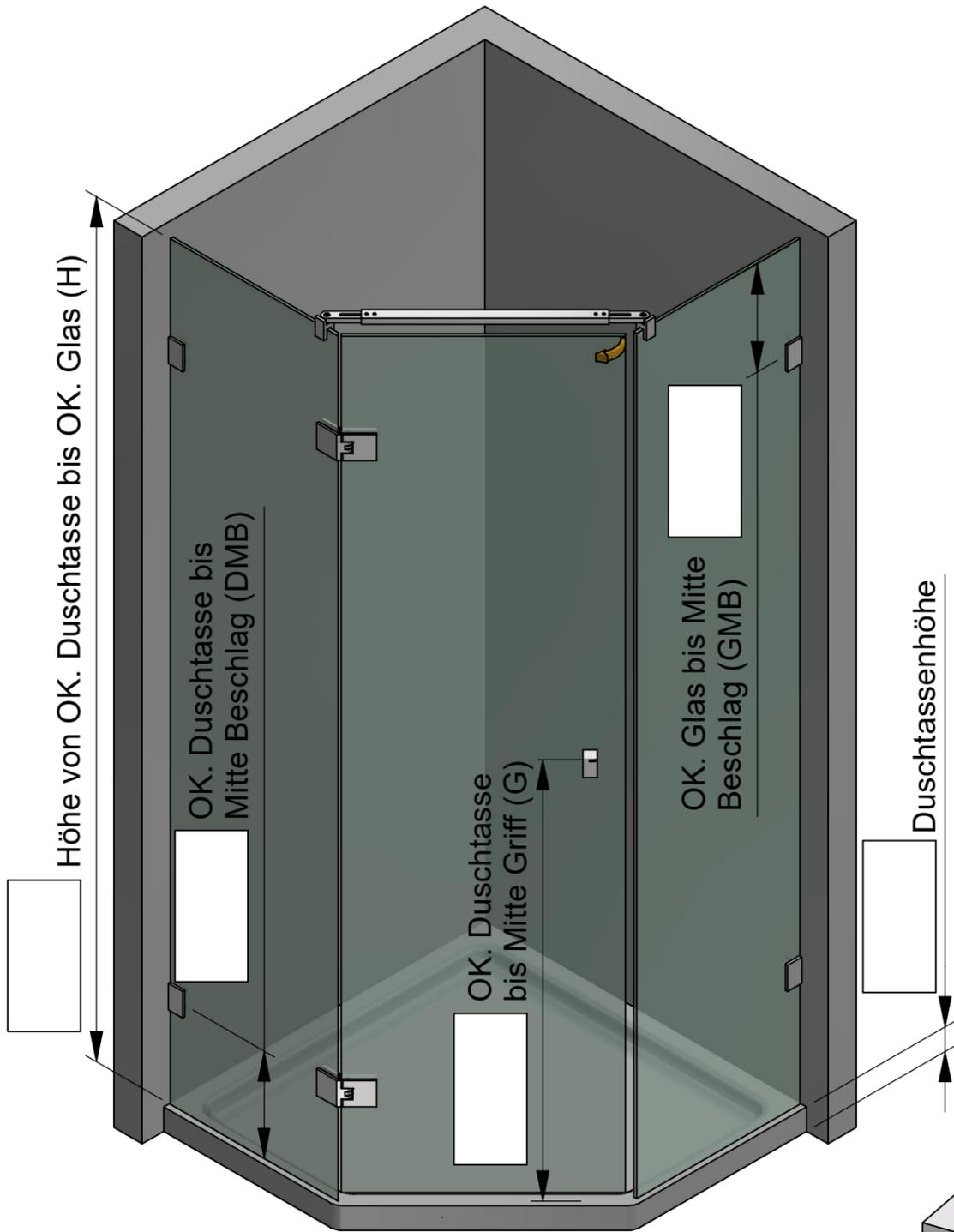
Die hier dargestellte Verwendung von Stabilisationsstangen ist als Beispiel anzusehen. Größe und Position der Stabilisationsstangen ist abhängig von der Glasgröße!
