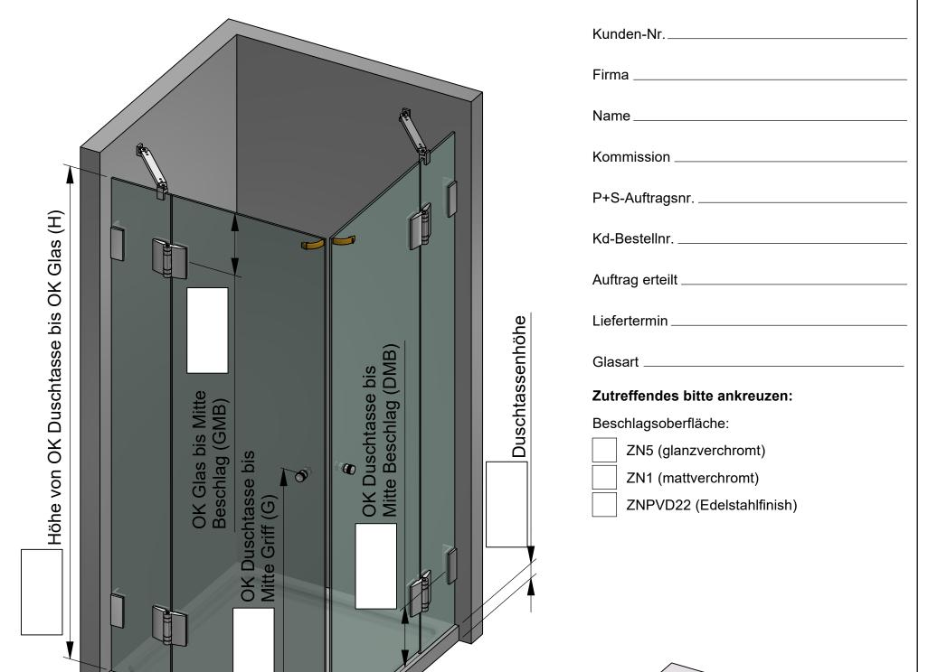
Die hier dargestellte Verwendung von Stabilisationsstangen ist als Beispiel anzusehen. Größe und Position der Stabilisationsstangen ist abhänging von der Glasgröße!
