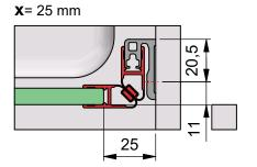
c) mit Dichtprofil 8855KU0-8 und Türanschlag-Trägerprofil 8880
