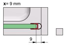
b) mit Dichtprofil 8851KU0-8 und Türanschlag-Trägerprofil 8880
