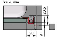
d) mit Dichtprofil 8861KU0-8 und Türanschlag-Trägerprofil 8880
