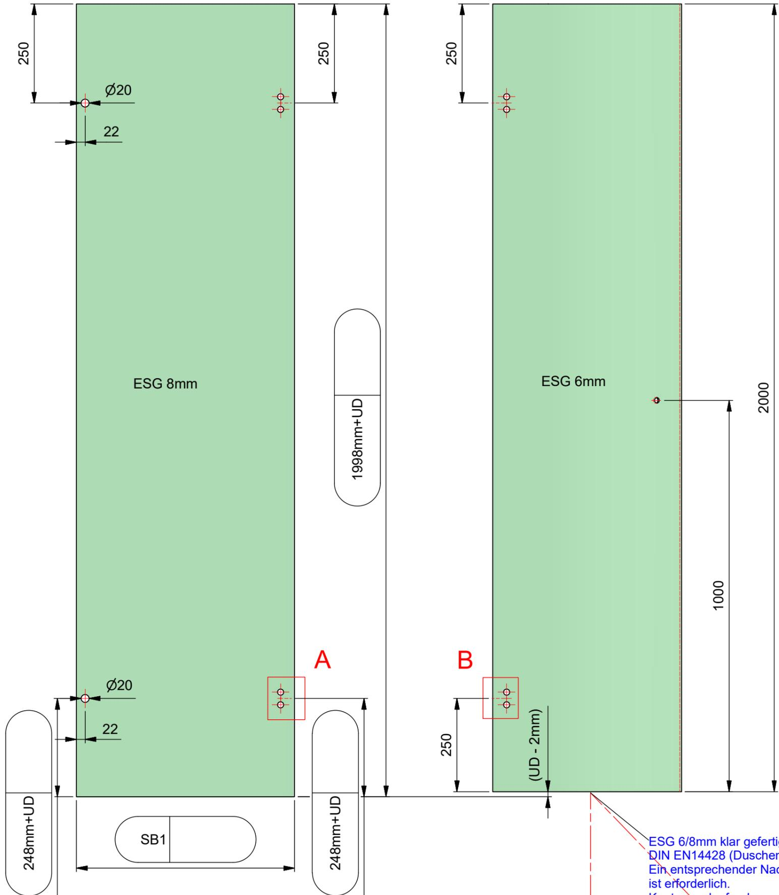
ESG 6/8mm klar gefertigt nach DIN EN14428 (Duschenglas). Ein entsprechender Nachweis (Stempel) ist erforderlich. Kanten umlaufend geschliffen und poliert. Alle Ecken stoßen oder leicht runden.
