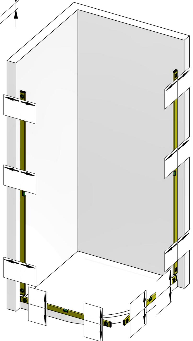
Die hier dargestellte Verwendung von Stabilisierungsstangen ist als Beispiel anzusehen. Größe und Position der Stabilisierungsstangen ist abhängig von der Glasgröße!
