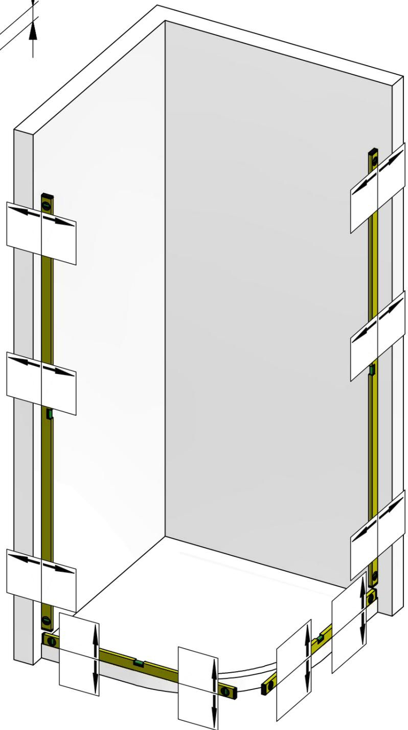
Die hier dargestellte Verwendung von Stabilisationsstangen ist als Beispiel anzusehen. Größe und Position der Stabilisationsstangen ist abhängig von der Glasgröße!
