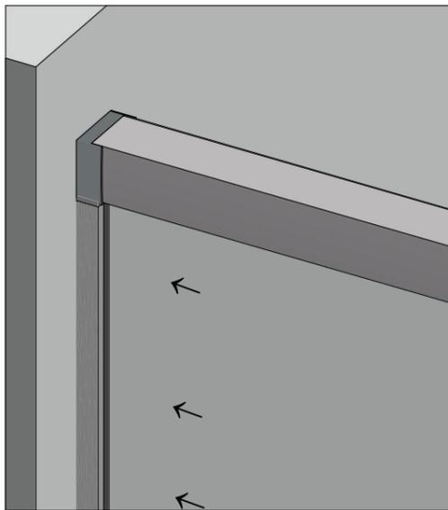
Laufschiene wird auf das Seitenteil geklemmt (AM=-30)
