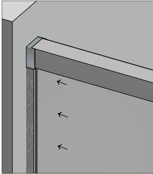
Laufschiene wird auf das Seitenteil geklemmt
