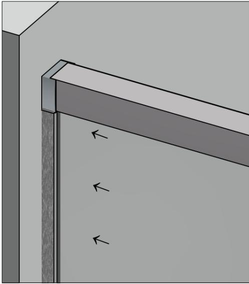
Laufschiene wird auf das Seitenteil geklemmt
