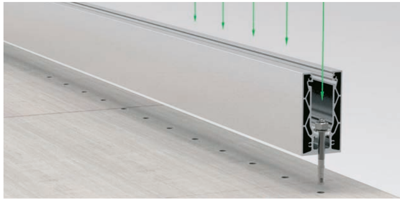
1. Profil anschrauben | mount the profile
