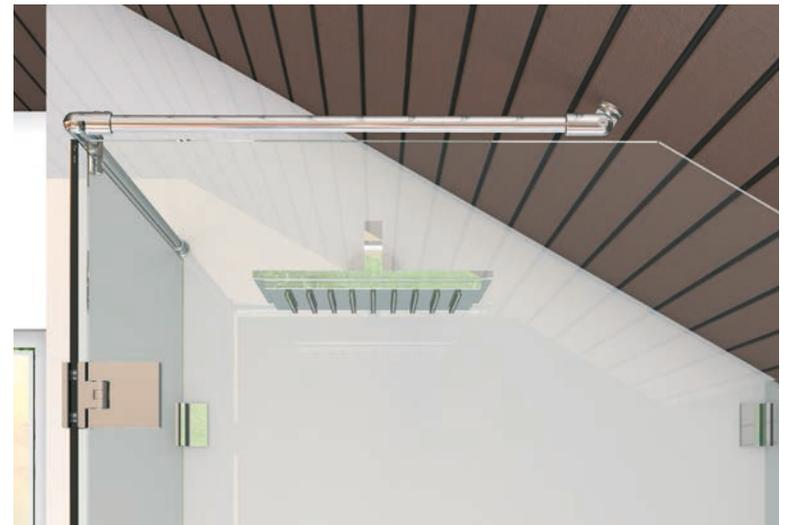
Pour la stabilité de la douche, nous recommandons que la barre de stabilisation ronde ou carrée re-coupable ne soit pas installée sur une longueur supérieure à 1200 mm. Veuillez en tenir compte lors de la conception: Un ensemble avec un système de rail filant n'a jamais la même stabilité au-dessus d'une certaine taille qu'un ensemble avec une barre stabilisatrice et une pièce en T.
