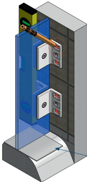
min. 2mm Unterlegematerial (klare PVC-Streifen, z.B. 8870KU0 o.Ä.)
