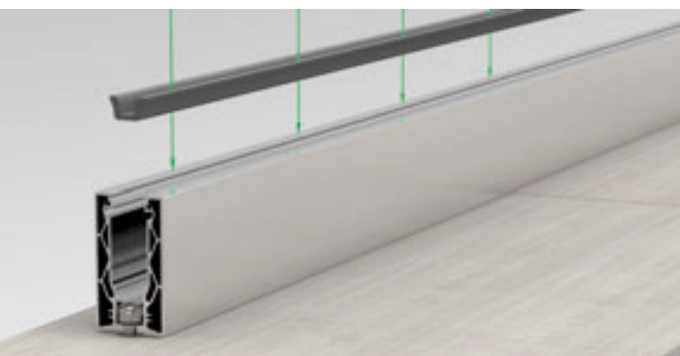
2. Installer le joint de fond de feuillure (faire une ouverture dans la zone extérieure au niveau des perçages d'évacuation des eaux)
