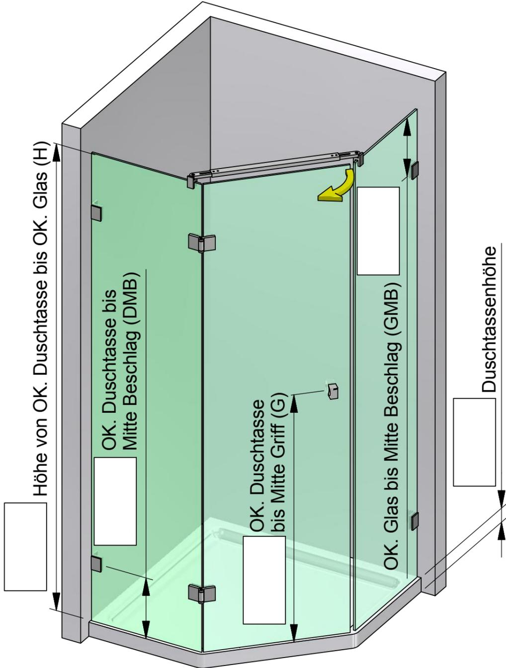
Die hier dargestellte Verwendung von Stabilisierungsstangen ist als Beispiel anzusehen. Größe und Position der Stabilisierungsstangen ist abhängig von der Glasgröße!
