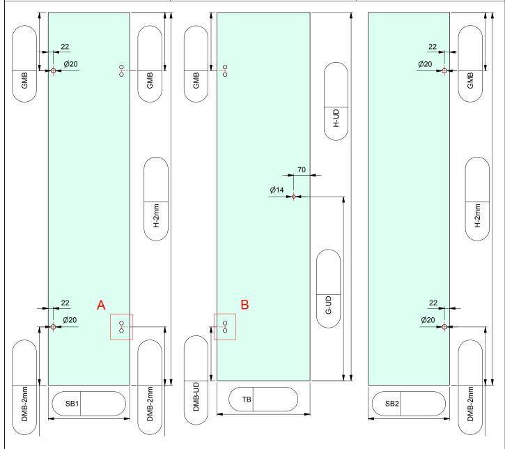
ESG 8mm klar gefertigt nach DIN EN14428 (Duschenglas). Ein entsprechender Nachweis(Stempel) ist erforderlich. Kanten umlaufend geschliffen und poliert. Alle Ecken stoßen oder leicht runden.
