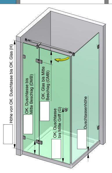
Die hier dargestellte Verwendung von Stabilisationsstangen ist als Beispiel anzusehen. Größe und Position der Stabilisationsstangen ist abhänging von der Glasgröße!
