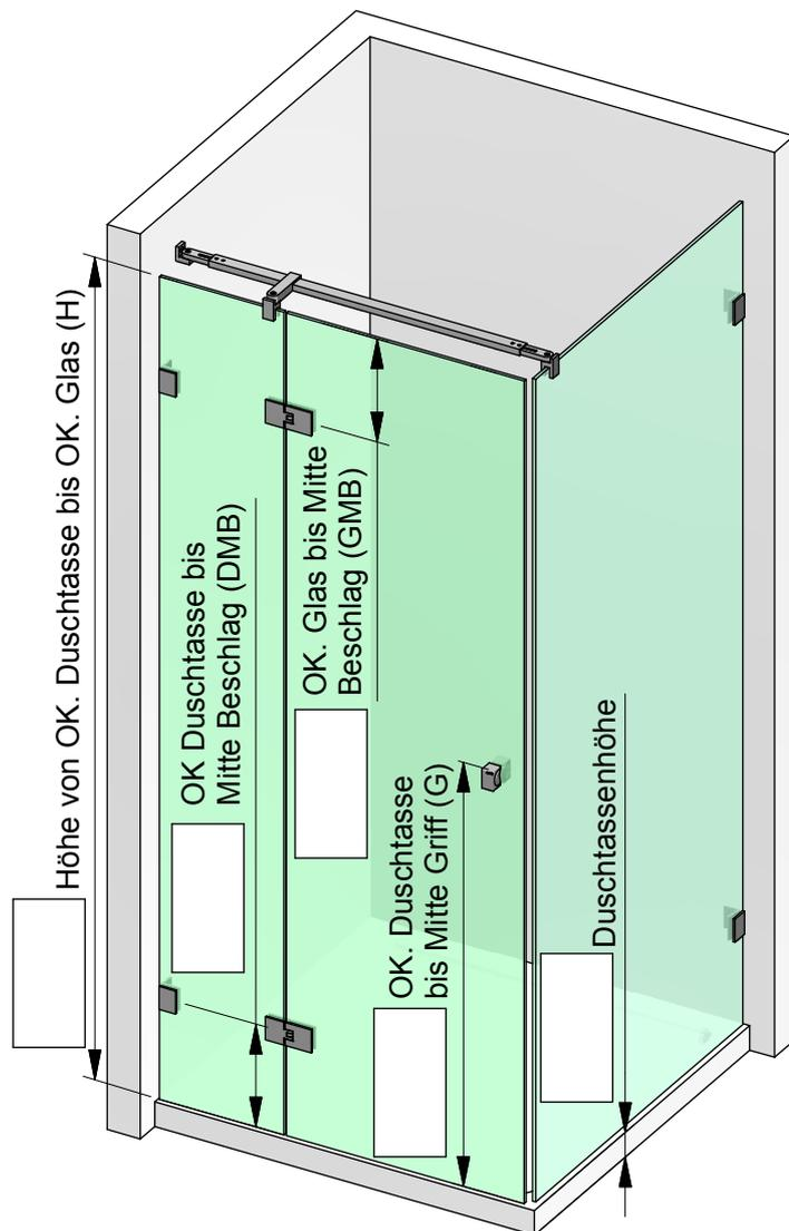
Die hier dargestellte Verwendung von Stabilisierungsstangen ist als Beispiel anzusehen. Größe und Position der Stabilisierungsstangen ist abhängig von der Glasgröße!
