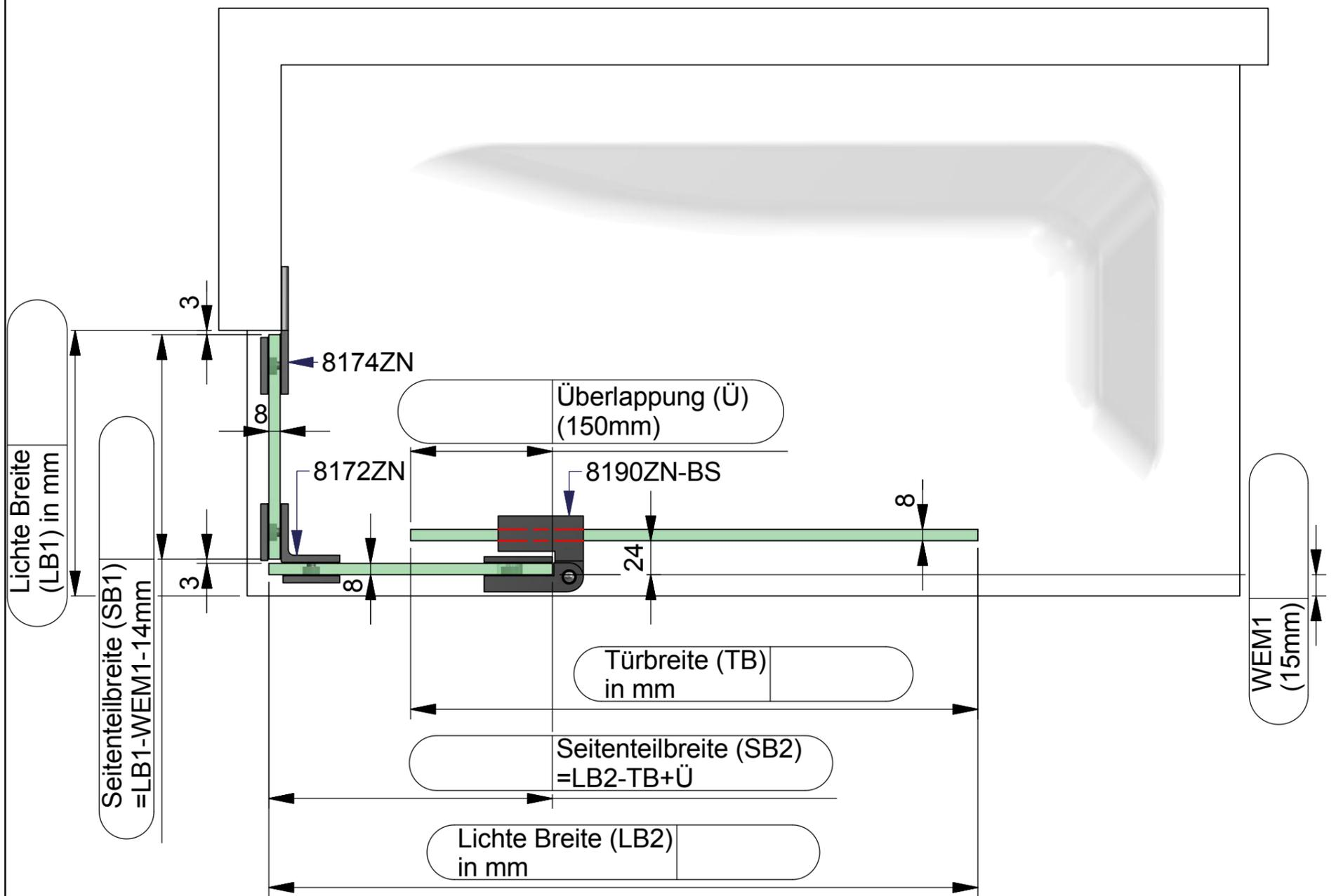
Verstellbereich für den Türflügel bei den unterschiedlichen Überlappungen (Ü). Mindestüberlappung sollte aus Gründen der Dichtigkeit nicht unterschritten werden.
