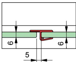
Verstellbereich für den Türflügel bei den unterschiedlichen Überlappungen (Ü). Mindestüberlappung sollte aus Gründen der Dichtigkeit nicht unterschritten werden.
