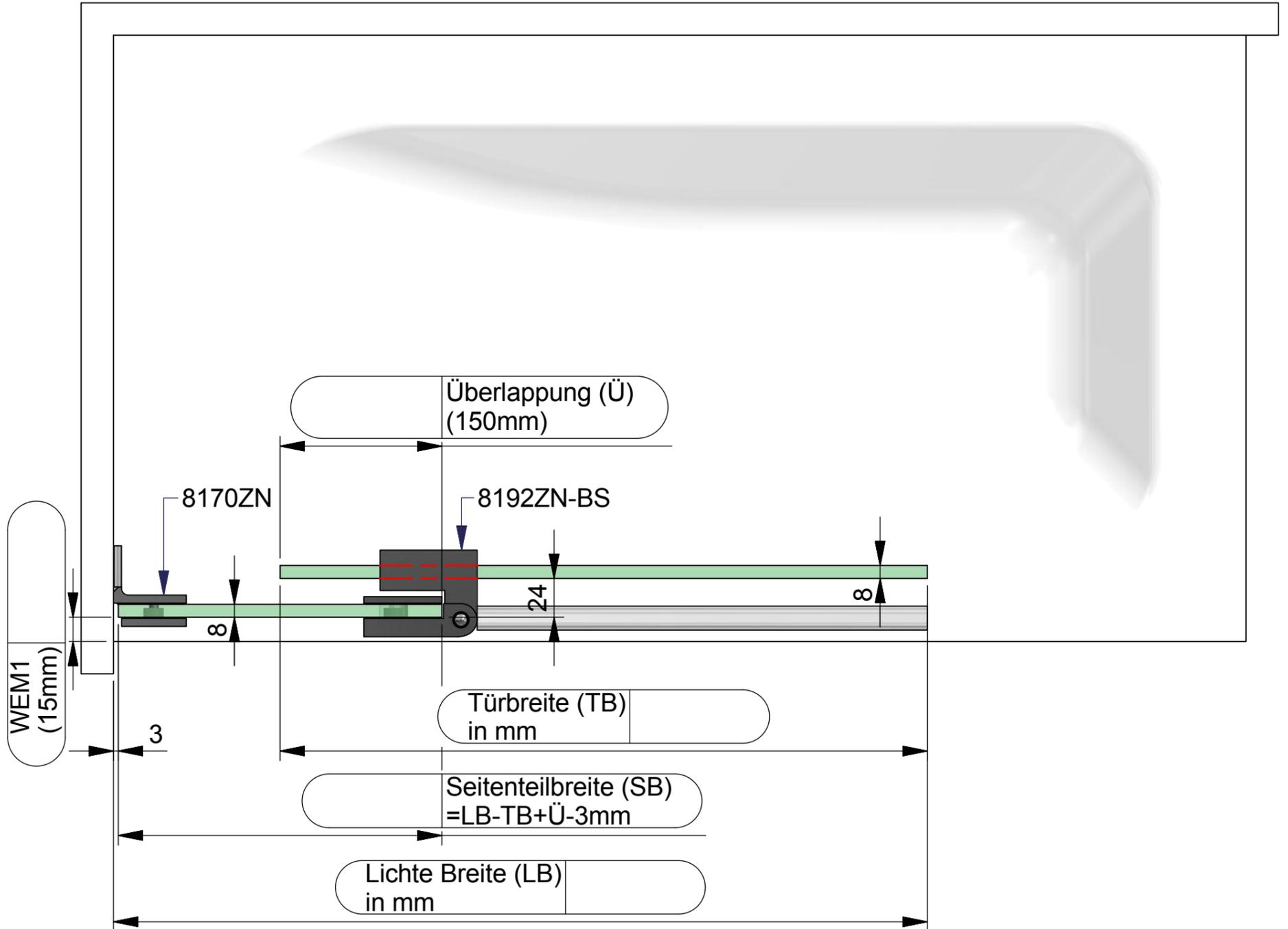
Verstellbereich für den Türflügel bei den unterschiedlichen Überlappungen (Ü). Mindestüberlappung sollte aus Gründen der Dichtigkeit nicht unterschritten werden.
