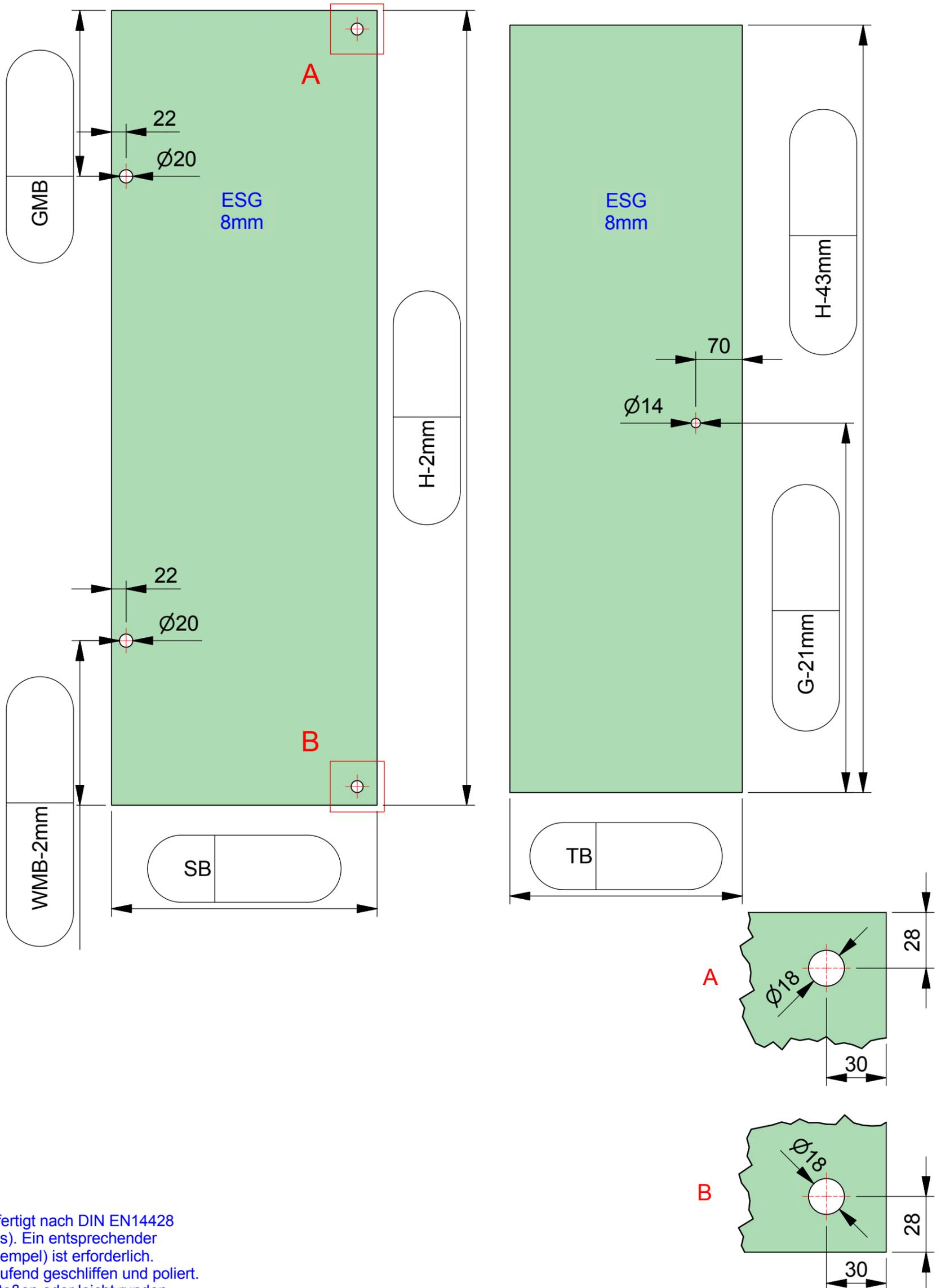
ESG klar gefertigt nach DIN EN14428 (Duschglas). Ein entsprechender Nachweis(Stempel) ist erforderlich. Kanten umlaufend geschliffen und poliert. Alle Ecken stoßen oder leicht runden.
