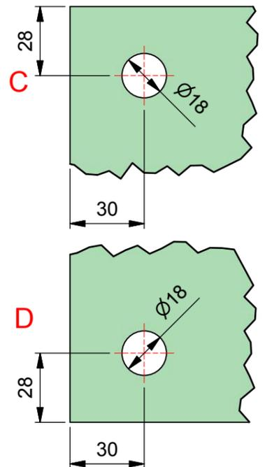
ESG klar gefertigt nach DIN EN14428 (Duschenglas). Ein entsprechender Nachweis(Stempel) ist erforderlich. Kanten umlaufend geschliffen und poliert. Alle Ecken stoßen oder leicht runden.
