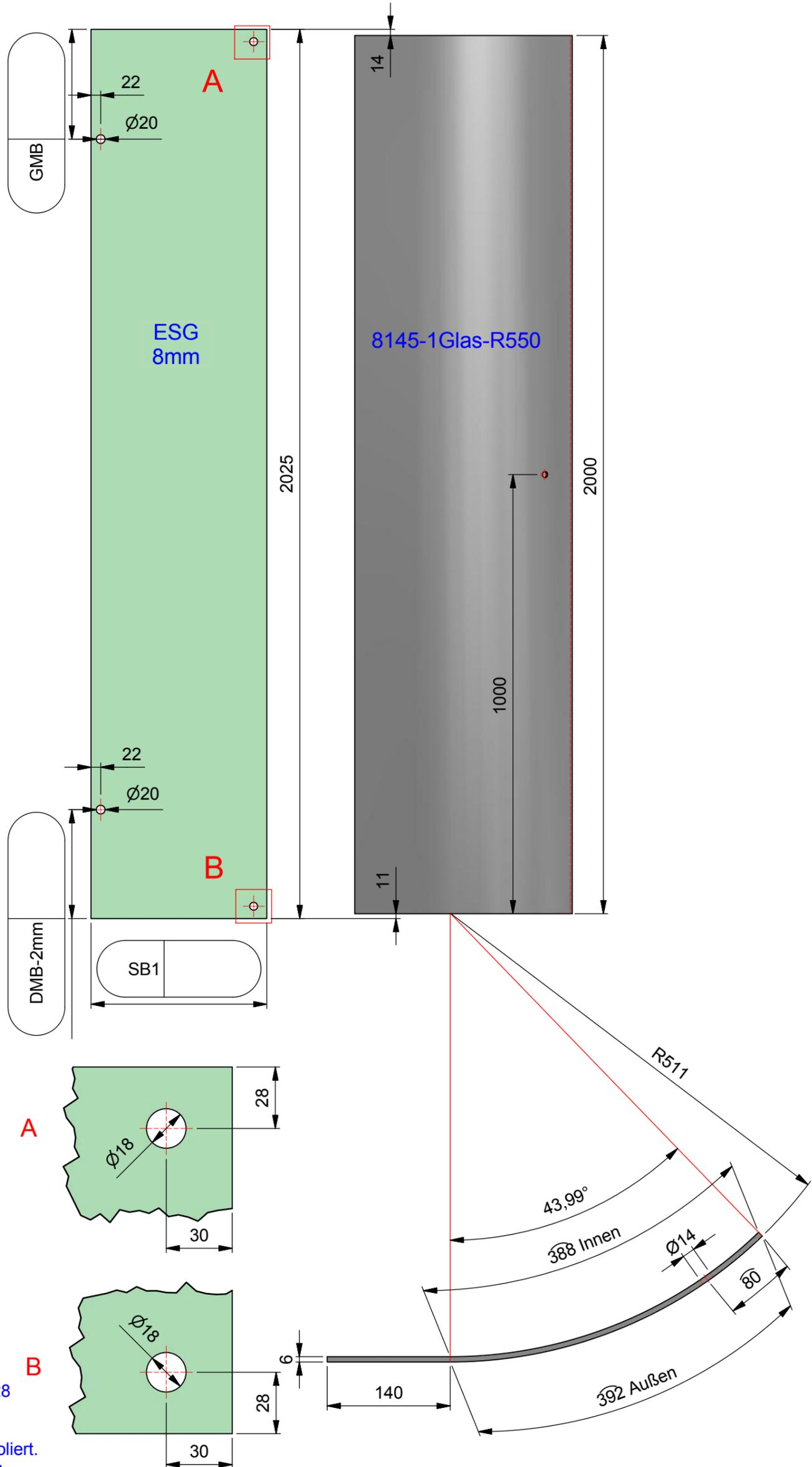
ESG klar gefertigt nach DIN EN14428 (Duschenglas). Ein entsprechender Nachweis(Stempel) ist erforderlich. Kanten umlaufend geschliffen und poliert. Alle Ecken stoßen oder leicht runden.
