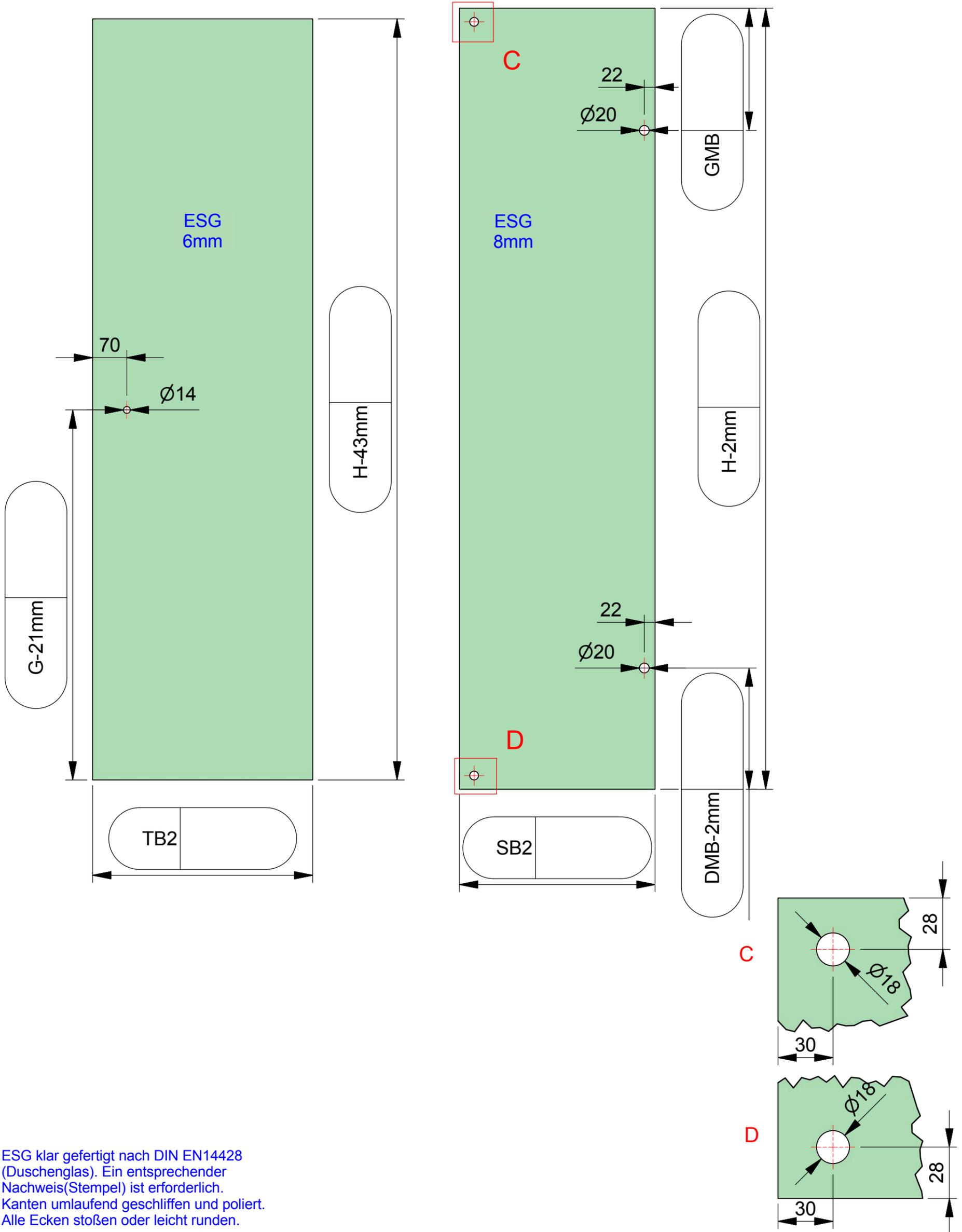
ESG klar gefertigt nach DIN EN14428 (Duschenglas). Ein entsprechender Nachweis(Stempel) ist erforderlich. Kanten umlaufend geschliffen und poliert. Alle Ecken stoßen oder leicht runden.
