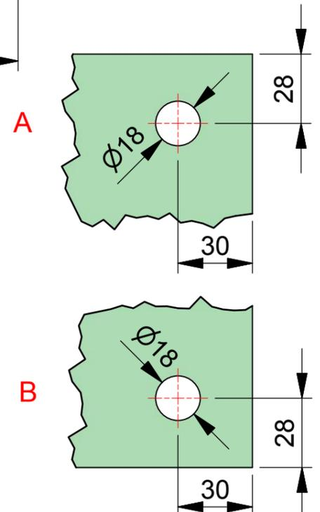
ESG klar gefertigt nach DIN EN14428 (Duschglas). Ein entsprechender Nachweis(Stempel) ist erforderlich. Kanten umlaufend geschliffen und poliert. Alle Ecken stoßen oder leicht runden.
