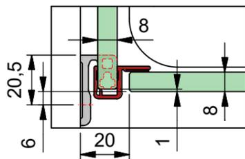
c) mit Dichtprofil 8861KU0-8 und Türanschlag-Trägerprofil 8880
