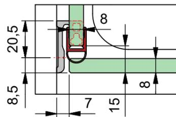
d) mit Dichtprofil 8861KU0-8 und Türanschlag z.B. 8274
