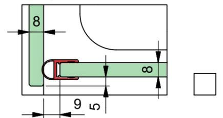
e) mit Dichtprofil 8849KU0-8 und Trägerprofil 8880
