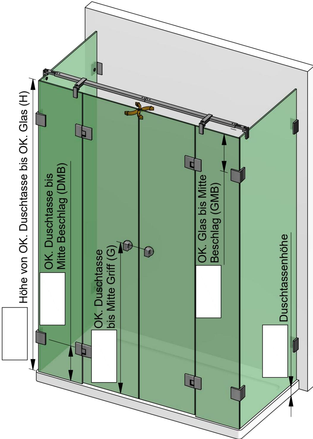
Die hier dargestellte Verwendung von Stabilisationsstangen ist als Beispiel anzusehen. Größe, Position und Art der Stabilisationsstangen ist abhängig von der Glasgröße und der Öffnungsrichtung!
