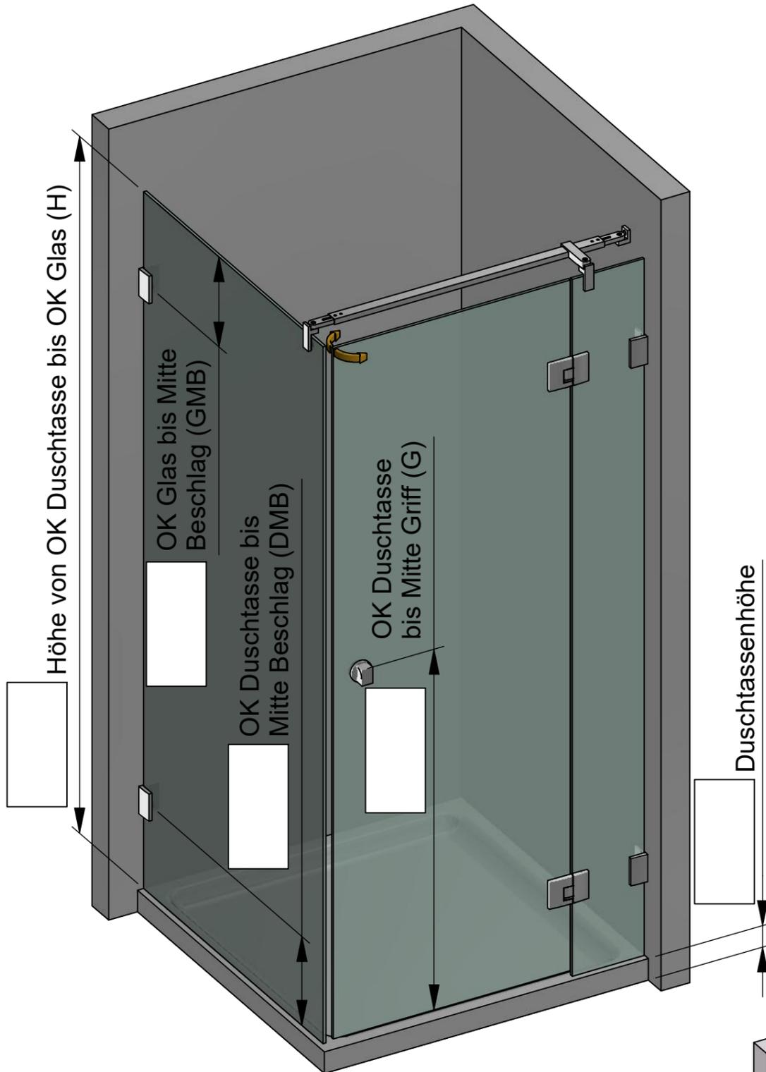
Die hier dargestellte Verwendung von Stabilisierungsstangen ist als Beispiel anzusehen. Größe, Position und Art der Stabilisierungsstangen ist abhängig von der Glasgröße und der Öffnungsrichtung!
