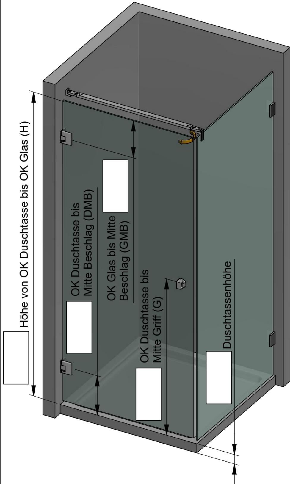
Die hier dargestellte Verwendung von Stabilisierungsstangen ist als Beispiel anzusehen. Größe, Position und Art der Stabilisierungsstangen ist abhängig von der Glasgröße und der Öffnungsrichtung!
