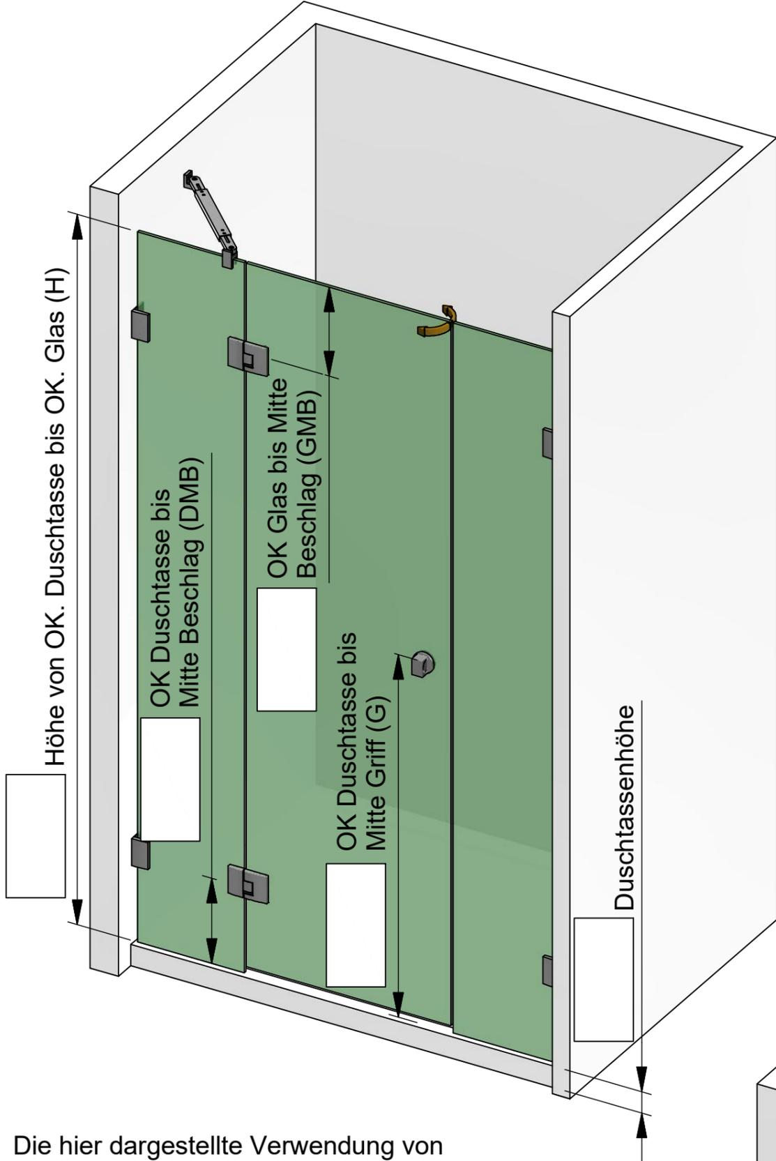
Die hier dargestellte Verwendung von Stabilisationsstangen ist als Beispiel anzusehen. Größe, Position und Art der Stabilisationsstangen ist abhängig von der Glasgröße und der Öffnungsrichtung!
