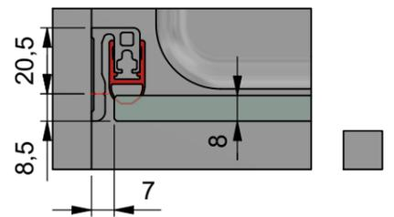
e) mit Dichtprofil 8849KU0-8 und Trägerprofil 8880
