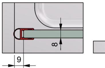
b) mit Dichtprofil 8851KU0-8 und Türanschlag-Trägerprofil 8880
