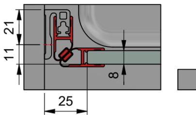
c) mit Dichtprofil 8855KU0-8 und Türanschlag-Trägerprofil 8880
