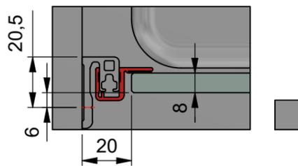
d) mit Dichtprofil 8861KU0-8 und Türanschlag-Trägerprofil 8880
