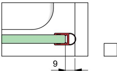
b) mit Dichtprofil 8851KU0-8 und Türanschlag-Trägerprofil 8880
