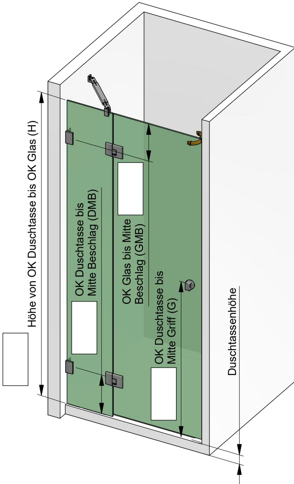
Die hier dargestellte Verwendung von Stabilisationsstangen ist als Beispiel anzusehen. Größe, Position und Art der Stabilisationsstangen ist abhängig von der Glasgröße und der Öffnungsrichtung!
