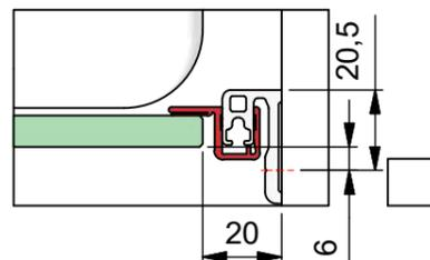
d) mit Dichtprofil 8861KU0-8 und Türanschlag-Trägerprofil 8880
