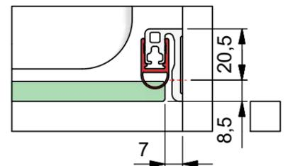
e) mit Dichtprofil 8849KU0-8 und Trägerprofil 8880
