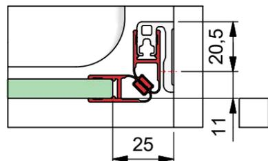
c) mit Dichtprofil 8855KU0-8 und Türanschlag-Trägerprofil 8880
