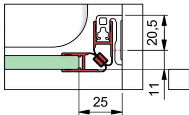
c) mit Dichtprofil 8855KU0-8 und Türanschlag-Trägerprofil 8880
