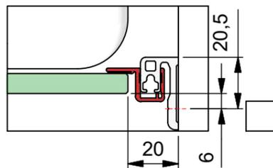
d) mit Dichtprofil 8861KU0-8 und Türanschlag-Trägerprofil 8880
