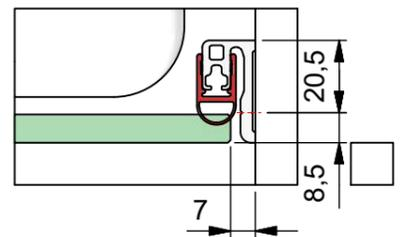
e) mit Dichtprofil 8849KU0-8 und Trägerprofil 8880
