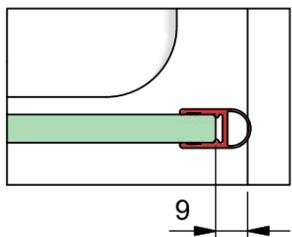
b) mit Dichtprofil 8851KU0-8 und Türanschlag-Trägerprofil 8880
