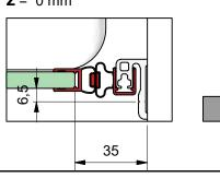
b) mit Dichtprofil 8851KU0-8 und Türanschlag-Trägerprofil 8880
