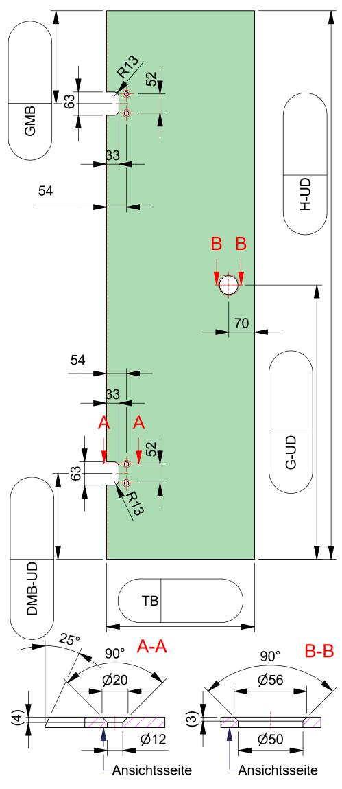
ESG 8mm klar gefertigt nach DIN EN14428 (Duschenglas). Ein entsprechender Nachweis(Stempel) ist erforderlich. Kanten umlaufend geschliffen und poliert. Alle Ecken stoßen oder leicht runden.
