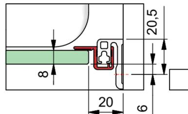
d) mit Dichtprofil 8861KU0-8 und Türanschlag-Trägerprofil 8880
