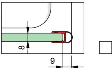
b) mit Dichtprofil 8851KU0-8 und Türanschlag-Trägerprofil 8880
