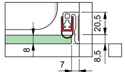
e) mit Dichtprofil 8849KU0-8 und Trägerprofil 8880
