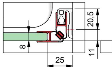
c) mit Dichtprofil 8855KU0-8 und Türanschlag-Trägerprofil 8880
