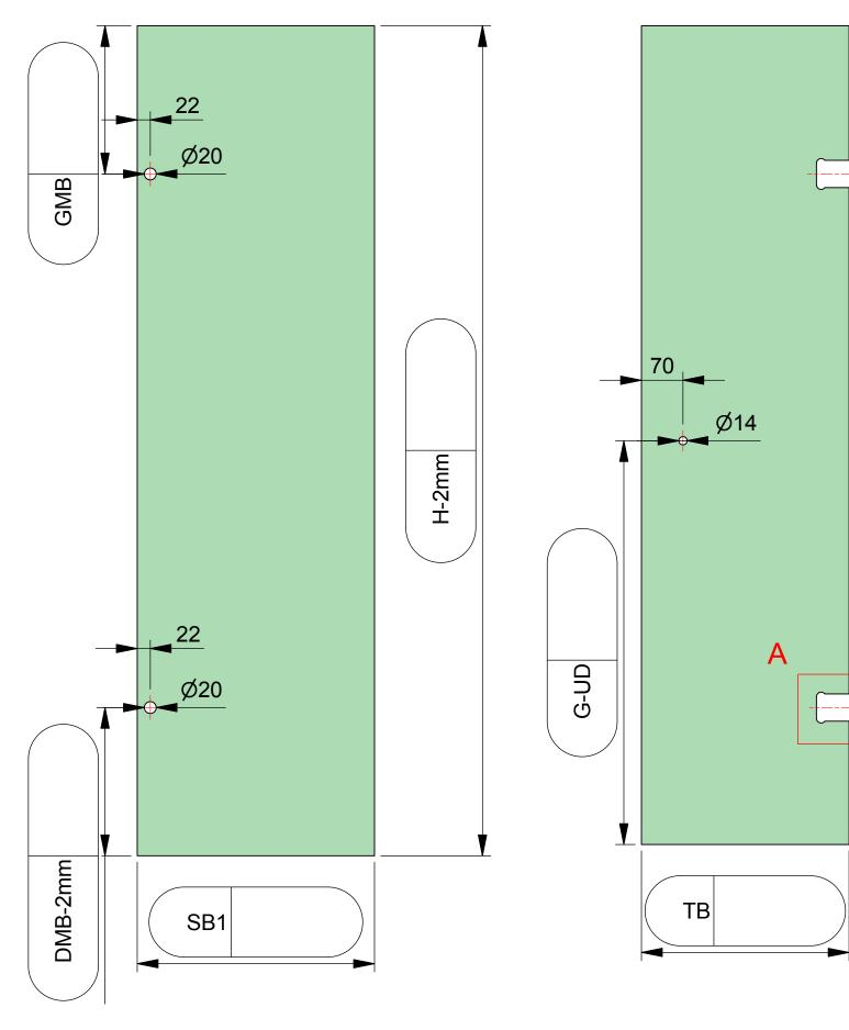
ESG 8mm klar gefertigt nach DIN EN14428 (Duschenglas). Ein entsprechender Nachweis(Stempel) ist erforderlich. Kanten umlaufend geschliffen und poliert. Alle Ecken stoßen oder leicht runden.
