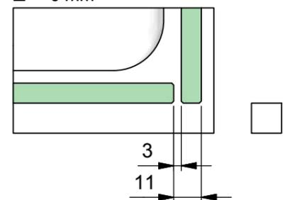
**ACHTUNG:** Seitenteil muss bei dieser Anwendung ausreichend ausgesteift sein!
