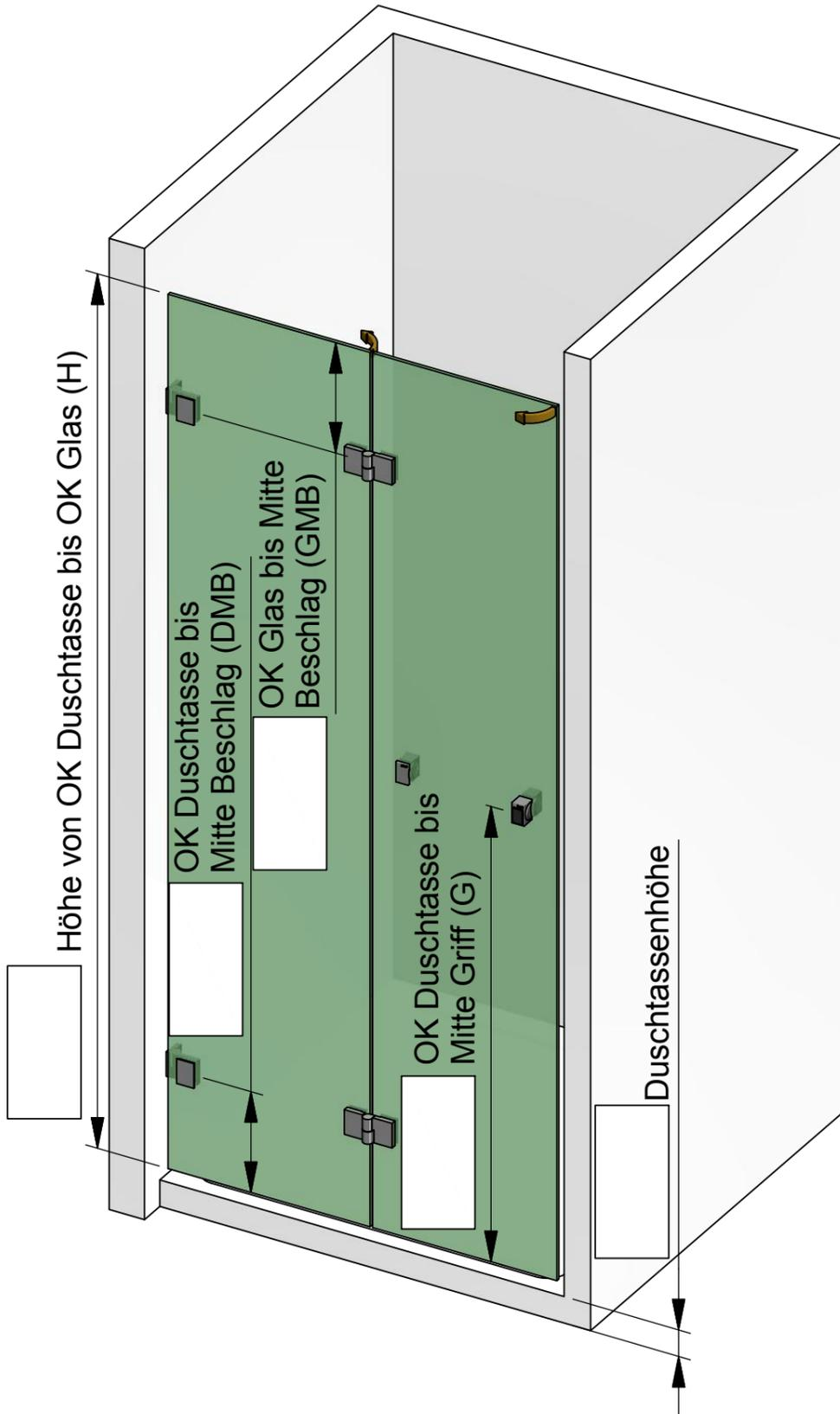
**Achtung: Bei nicht lotrechten Wänden mit Winkeln zwischen Boden und Wand von unter 90° können mit Nivello keine Falttüren gebaut werden! Im gefalteten Zustand bleibt der erste Türflügel nicht in dieser Position.**
