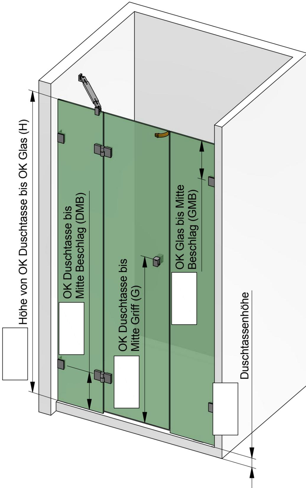
Die hier dargestellte Verwendung von Stabilisationsstangen ist als Beispiel anzusehen. Größe und Position der Stabilisationsstangen ist abhängig von der Glasgröße!
