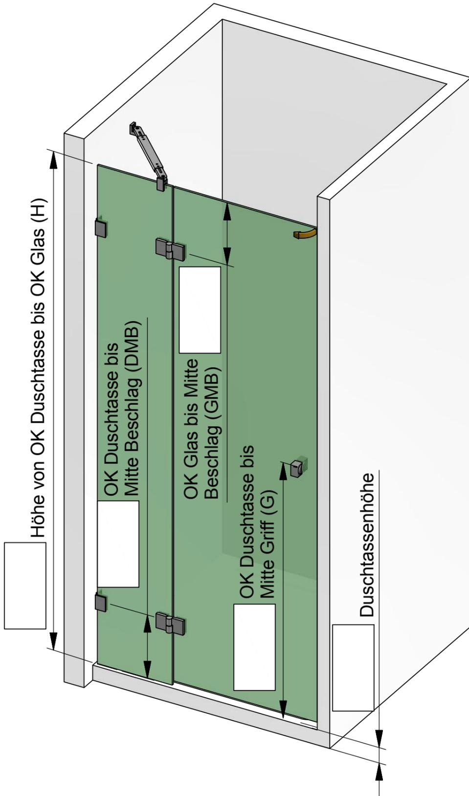
Die hier dargestellte Verwendung von Stabilisationsstangen ist als Beispiel anzusehen. Größe und Position der Stabilisationsstangen ist abhängig von der Glasgröße!
