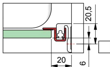
d) mit Dichtprofil 8861KU0-8 und Türanschlag-Trägerprofil 8880
