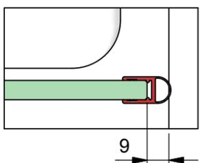
b) mit Dichtprofil 8851KU0-8 und Türanschlag-Trägerprofil 8880
