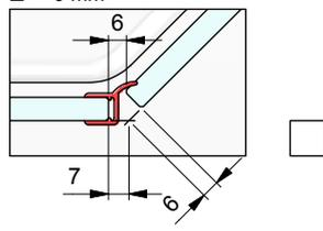
Folgende Abzugs- bzw. Zuschlagsmaße müssen mit der Duschtassenschenkellänge verrechnet werden um das Lichtes Maß bei den unterschiedlichen Wanneneinrückmaßen
