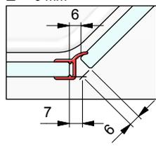
Folgende Abzugs- bzw. Zuschlagsmaße müssen mit der Duschtassenschenkellänge verrechnet werden um das Lichtes Maß bei den unterschiedlichen Wanneneinrückmaßen
