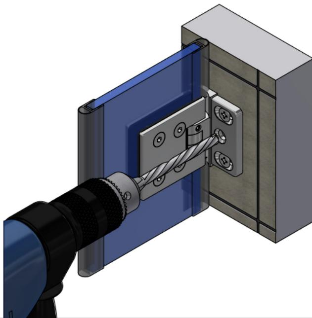
Ist die Dusche fertig aufgebaut und ausgerichtet, können die Bänder endgültig fixiert werden. Das Duschband ist so konstruiert, dass die Befestigungsbohrung mit einem 8-mm-Bohrer im montierten Zustand ausgeführt werden kann.
