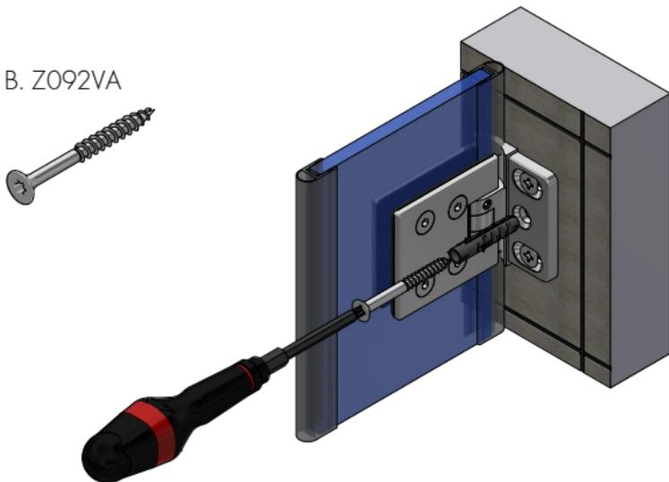
Wichtig: Die Schrauben sollten aus Edelstahl A2 oder A4 bestehen und einen Senkkopfdurchmesser von **min. 10 mm und max. 12 mm** aufweisen. Bitte die entsprechende Kopfhöhe prüfen, so dass die Schrauben das Befestigen der Abdeckkappen 8130-18ZN, am Ende der Duschenmontage, nicht behindern.
