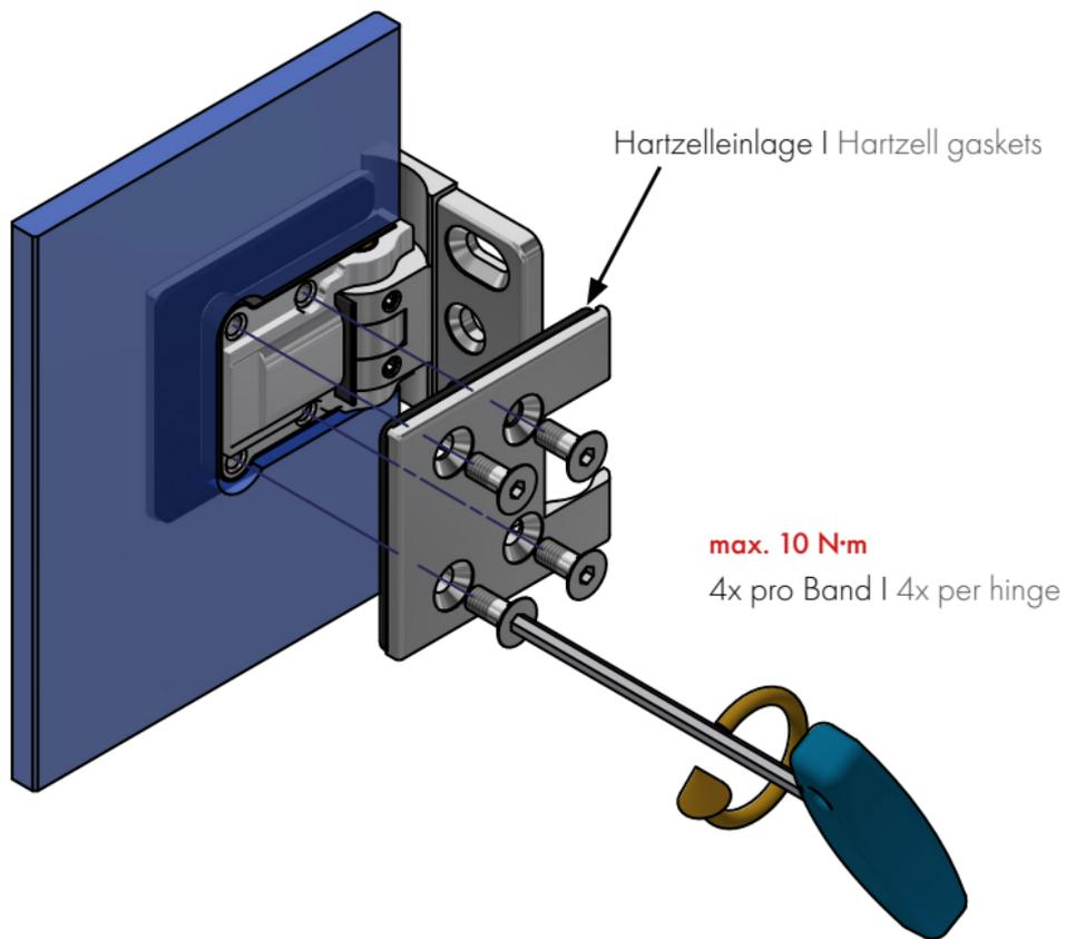
Das Gehäuse des Duschtürbandes mittig im Glasausschnitt positionieren, um den grösstmöglichen Verstellbereich für die Einstellung der Dusche zu gewährleisten. Die Schrauben sind wechselweise bis zum Erreichen des max. Anzugsmomentes von 10N·m anzuziehen. Nach ca. 15 Minuten noch einmal wechselseitig auf das max. Anzugsmoment nachziehen.
