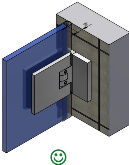
Um ein Kippen der Drehachse zu verhindern, sollte das Duschtürband immer vollflächig auf einer Fliese montiert werden!
