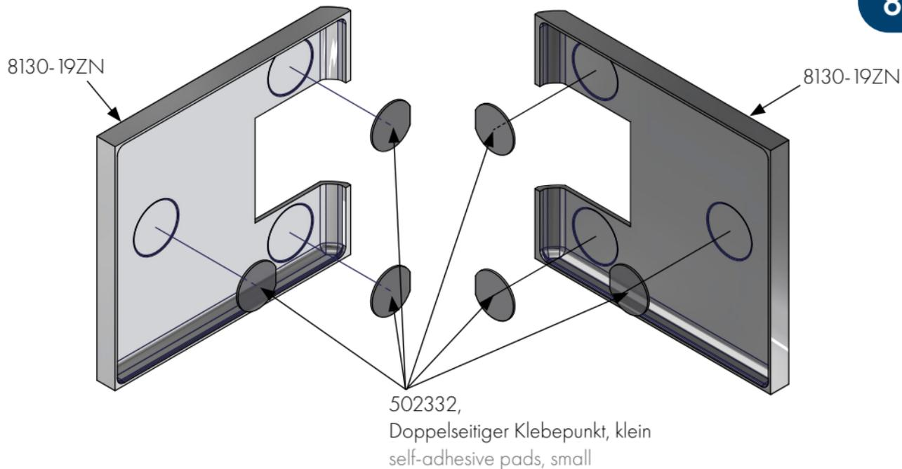
Die Abdeckkappen 8130-19ZN werden ebenfalls mit Klebepunkten Best.-Nr. 502332 am Duschtürband fixiert. Diese kleben Sie bitte vor dem Aufsetzen der Kappe 8130-19ZN in die dafür vorgesehenen Vertiefungen.
