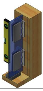
Aufsetzen des Türflügels auf den Saunaboden mit den vormontierten Duschbändern. Um den unteren Abstand für den Türflügel sicherzustellen, sollte der Türflügel mit Montageklötzen in der Höhe des beabsichtigten Abzugsmasses unterklotzt werden. Place the door panel on the sauna base with the pre-assembled sauna hinge.s In order to ensure the correct distance of the door panel, the door panel should be rested on mounting blocks in the same height as the the intended deduction dimension.
