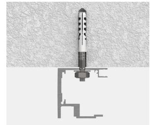
Bei der Verwendung von Profil 8820-70 werden für die Deckenmontage Stockschraben benötigt. TYP23E – M5
