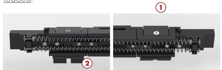
Bei Verwendung des einseitigen Softstopp (Art-Nr.: 8822ZN-SSD-32/60), muss dieser durch drehen der Kunststoffkappe ① an die linke und rechte Seite angepasst werden. Somit zeigen die Zapfen ② für die Glasführung immer nach unten.
