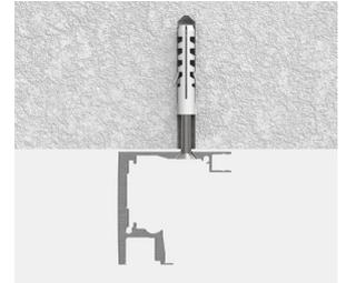
Bei der Verwendung von Profil 8820-62 werden für die Deckenmontage Senkkopf-Spanplattenschrauben benötigt.
