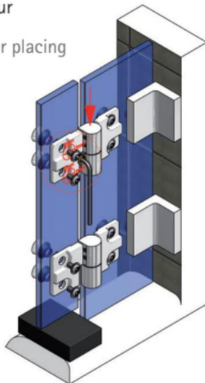
Um den späteren Abstand für die untere Dichtungslösung sicherzustellen, sollte der Türflügel mit Montageklötzen in der Höhe des beabsichtigten Abzugsmasses unterklotzt werden.
