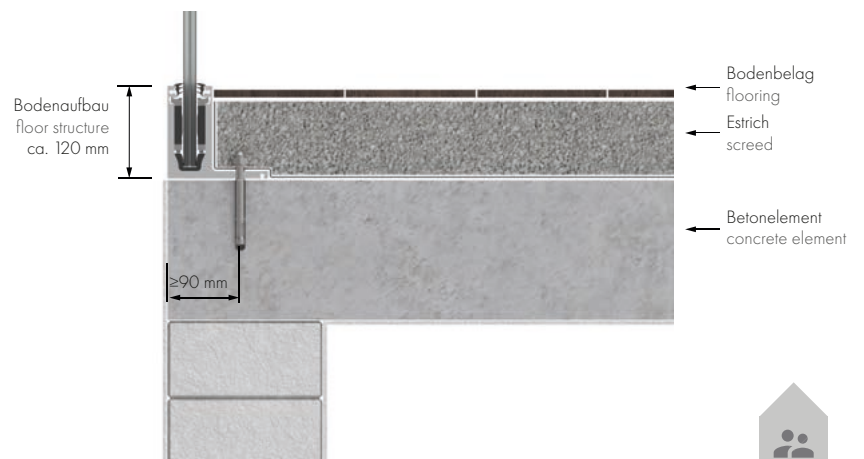
(E) Innenanwendung: Beispiel Empore/Laubengang mit eingelassenem Profil interior application: example porch / portico with recessed profile
