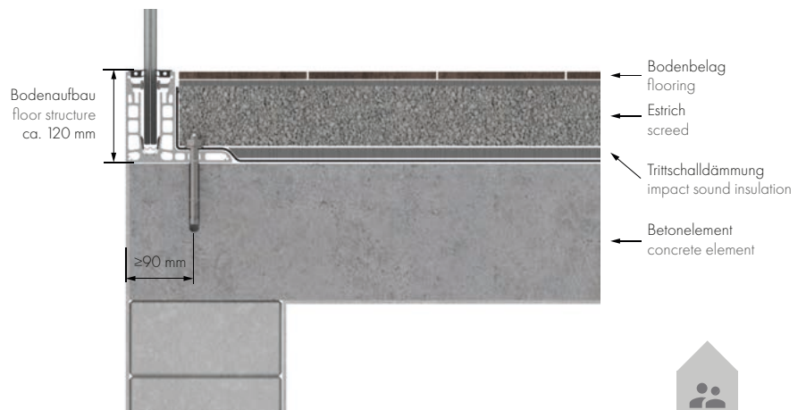
(E) Innenanwendung: Beispiel Empore/Laubengang mit eingelassenem Profil interior application: example porch / portico with recessed profile
