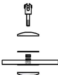
Montieren Sie das Glasprofil und die Punkthalter an der Vordachscheibe, ziehen Sie die Punkthalter mit einem Anzugsmoment von 16Nm an. Danach hängen Sie die Scheibe in den Anschluss unten ein.
