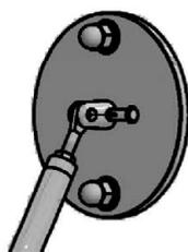
Schieben Sie nun die Zugstange K5 in den oberen Anschluss K3 und befestigen Sie die Zugstange mit dem Spreizbolzen
