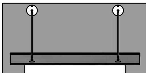
Jetzt schieben Sie die Zugstange in die vorderen Punkthalter und befestigen sie mit den Spreizbolzen.
