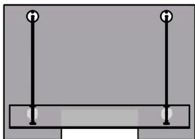
Jetzt heben Sie die Scheibe an, schieben die Zugstange in den vorderen Punkthalter und befestigen sie mit den Spreizbolzen.
