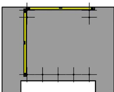
Zeichnen Sie die Bohrpunkte, siehe Auftragsbezogene Kundenzeichnung, mit geeigneten Messmitteln an. Bitte wählen Sie Art und Befestigung entsprechend der Belastbarkeit des Untergrundes und den örtlich zu erwartenden Belastungen. Bohren Sie entsprechend dem von Ihnen gewählten Befestigungsmaterial.
