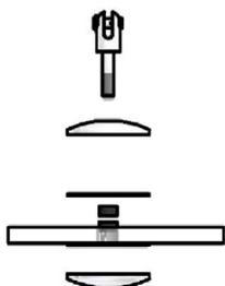
Montieren Sie die Punkthalter an der Vordachscheibe und ziehen Sie ihn mit einem Anzugsmoment von 16Nm an. Danach hängen Sie die Scheibe in den Anschluss unten ein und befestigen Sie die Punkthalter mit den Spreizbolzen.
