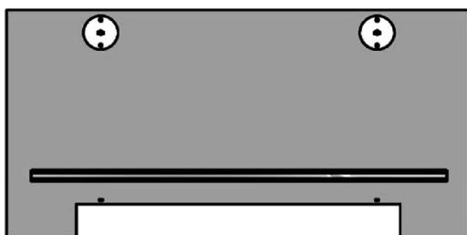
Befestigen Sie nun die Komponenten K3 (Anschluss oben) und die Komponenten K4 (Anschluss unten) mit entsprechenden Befestigungsmitteln an der Wand.
