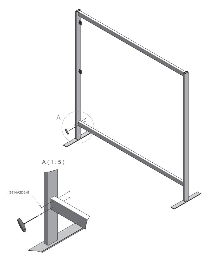
7. Kleben Sie die Klebepunkte 21000624 auf das Profil. Adhere the adhesive pads 21000624 to the profile.
