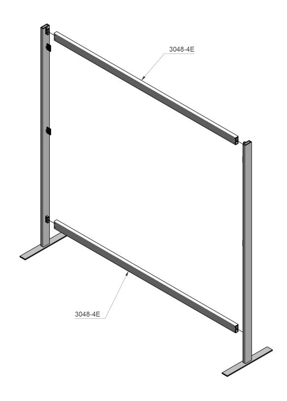
**6.**Verschrauben Sie die Profile mit den Madenschrauben S914A2D5x8.
