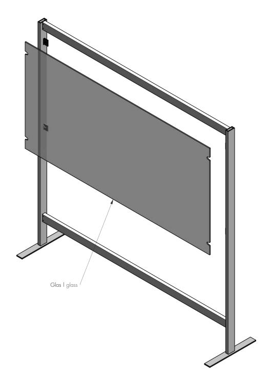
Befestigen Sie das Glas mit der Gegenplatte vom Winkelverbinder und ziehen Sie es mit dem Drehmomentschlüssel fest. Nach dem Ausrichten alle Schrauben bis zum Erreichen des max. Anzugsmomentes von 10 Nm anziehen. Nach ca. 15 Minuten noch einmal auf das max. Anzugsmoment nachziehen.
